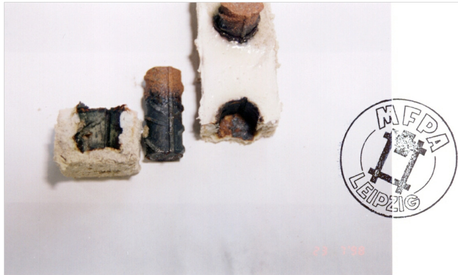
Az MFPA-Leipzig vizsgálati jelentéséből: HydroBloc® Injekt 583. Víz alatti tárolás, rozsdafoltok nélkül.
